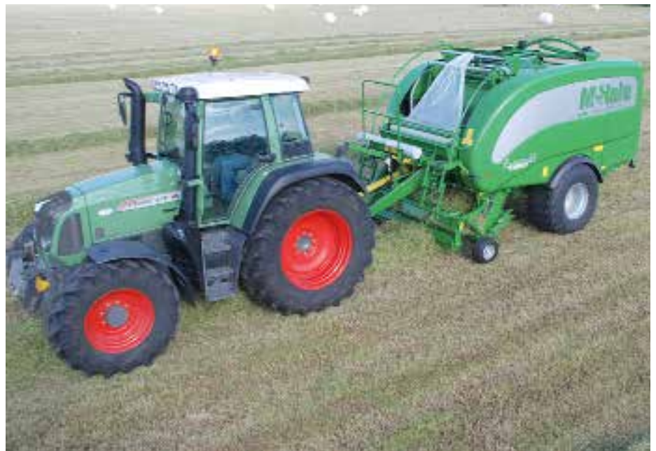
Kljub sorazmerno kompaktnim zunanjim meram zaradi masivne izdelave kombinirana balirka Fusion 3 plus tehta dobrih 6 ton.
