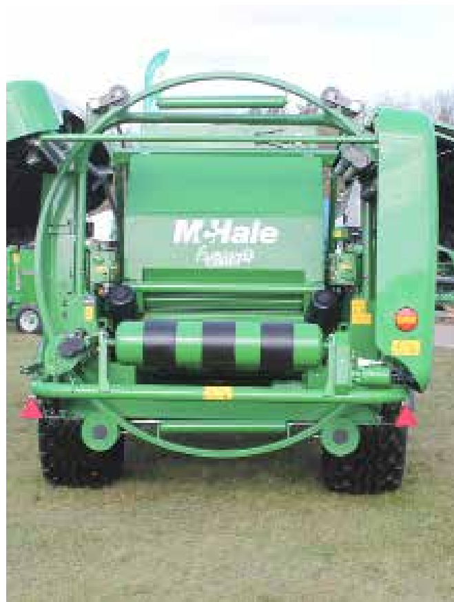
Stiskalna komora z močnimi valji, takoj za njo ovijalna miza in ovijalni obroči. Prenos bale iz komore na ovijalno mizo poteka brez težav tudi na nagnjenem terenu.
