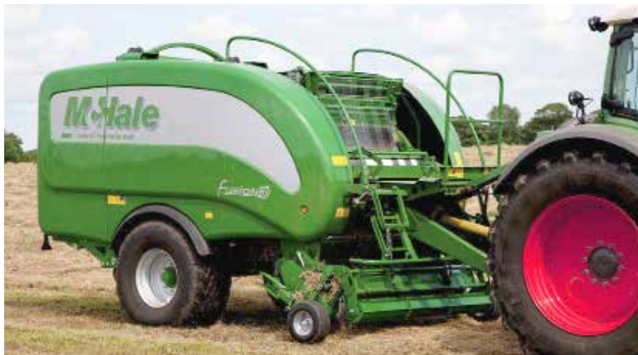
Pobiralo s poravnalnim valjem in dodatno ravnalno ploščino omogoča čisto pobiranje in enakomeren dotok mase v stiskalno komoro tudi pri velikih delovnih hitrostih.
